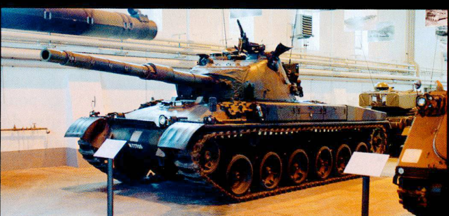
Plusieurs séries de chars 68 sont réalisées, avec un canon de 10,5 cm stabilisé. Ils utilisent une conduite de tir française et un moteur allemand, secondé par un agrégat ( Himo ) au bruit caractéristique...
