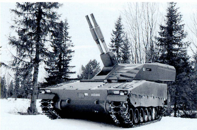
Le CV-90 est actuellement évalué avec la tourelle bitube 12 cm AMOS finlandaise. © Patria.
