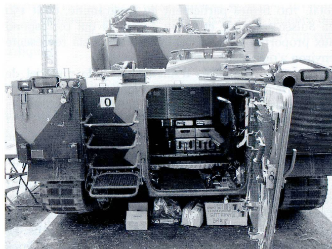
Les CV-90 suédois disposent d'une porte latérale motorisée. La version suisse dispose, quant à elle, d'une rampe verticale plus large.
