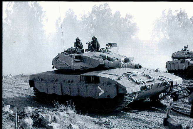
Ci-dessus et à gauche: Le Merkava 3 se reconnaît à ses blindages latéraux renforcés et inclinés. Le bouclier de tourelle est «percé» par le dispositif de visée du pointeur.
