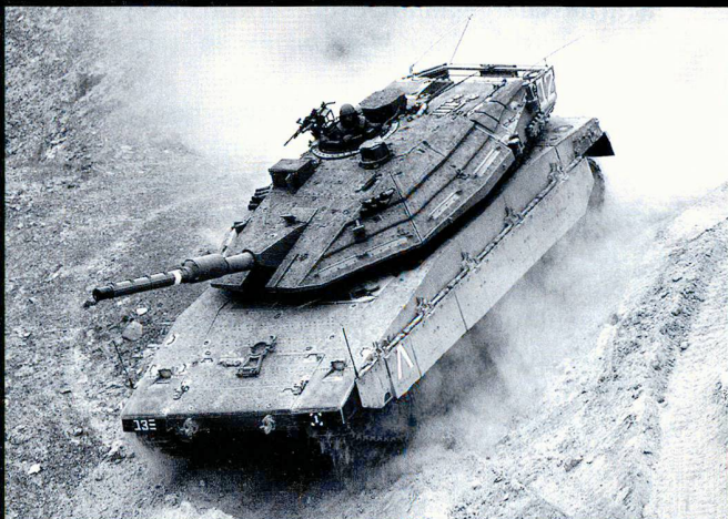
Ci-dessus et ci-dessous: Le Merkava 4 dispose d'un blindage amovible plus lisse que ses prédécesseurs. Le viseur principal est placé au-dessus de la tourelle. Mais l'essentiel des améliorations techniques est invisible pour les yeux... électronique, capteurs, contre-mesures électroniques. Au moins un char par compagnie dispose d'un système de déminage ou d'une lame de bulldozer.
