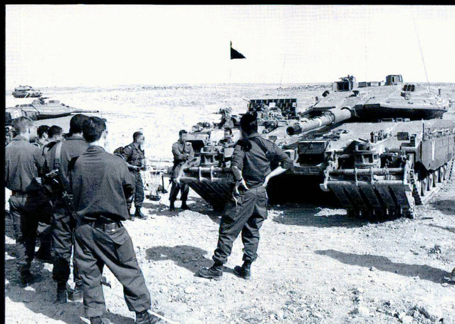
Ci-dessus et ci-dessous: Le Merkava 4 dispose d'un blindage amovible plus lisse que ses prédécesseurs. Le viseur principal est placé au-dessus de la tourelle. Mais l'essentiel des améliorations techniques est invisible pour les yeux... électronique, capteurs, contre-mesures électroniques. Au moins un char par compagnie dispose d'un système de déminage ou d'une lame de bulldozer.
