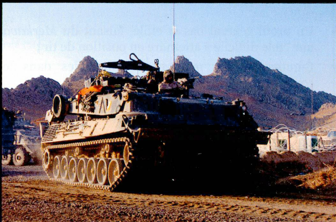
Le Badger est un engin du génie construit sur le châssis du Léopard 1.
