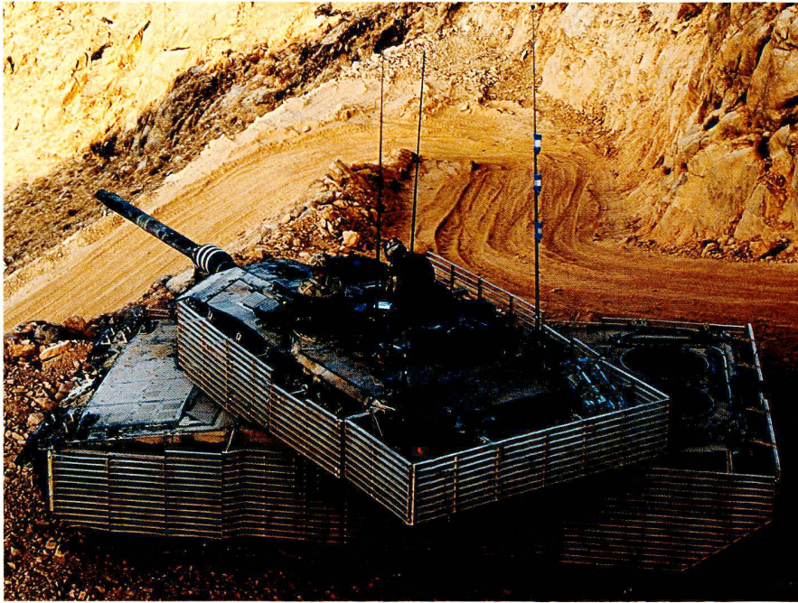
Les Léo 2A6M prélevés de la Bundeswehr ont été dotés de grillages anti-RPG et de protections supplémentaires sur la carcasse, pour lutter contre les mines et les explosifs improvisés (IED).
