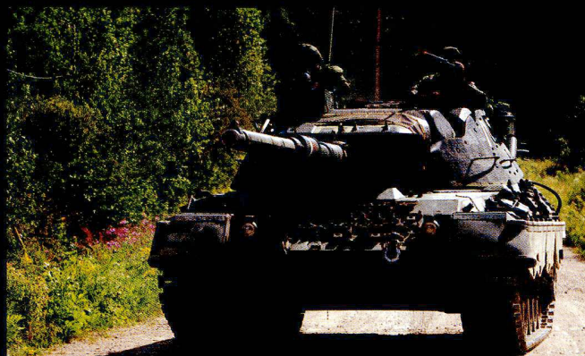
Le Léopard C2 a reçu la tourelle allemande A1A5 stabilisée et dotée d'un viseur thermique.
