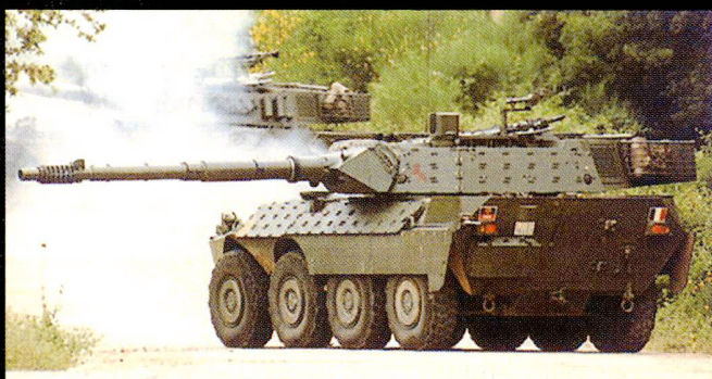
L'armée italienne, au sein de l'OTAN, dispose de réelle compétence dans la mise à disposition de forces légères, à l'instar du char léger à roues Centauro équipé d'une tourelle de 10,5 cm.
