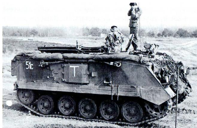
Le FV-432 est un véhicule transport de troupes (VTT) légèrement blindé conçu sur le modèle du M-113.
