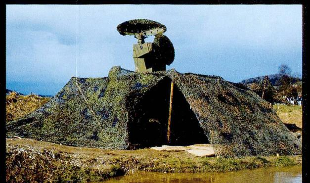
L'appareil de conduite de tir comprend un radar de surveillance, un radar de poursuite, ainsi qu'un viseur optique jour/nuit.
