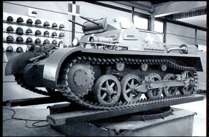
Le PzKpfw I allemand de 2 hommes n'emporte que 2 mitrailleuses de 7,92 mm.
