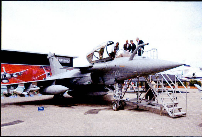
Le Rafale version armée de l'Air se distingue par un train et une crose plus légers que son frère de l'Aéronavale. Celui-ci est présenté sur le stand Dassault.
