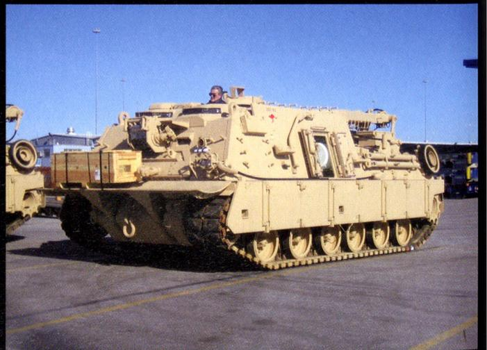
Les insuffisances du M88 (56 t) ont conduit au développement du M88A2 Hercules (70 t), afin de permettre le tractage d'un M1A1
