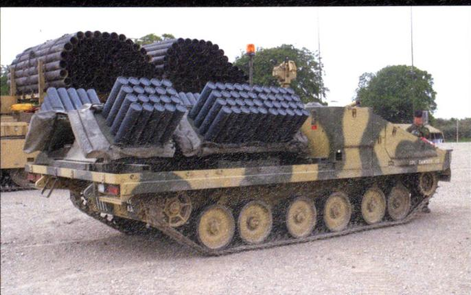
Le système *Volcano* permet de créer rapidement des champs de mines à distance de sécurité.
