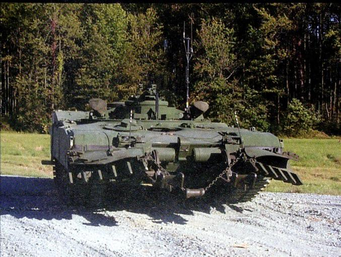
Le M1 *Panther II* est un engin de déminage télécommandé, également sur châssis *Abrams*.
