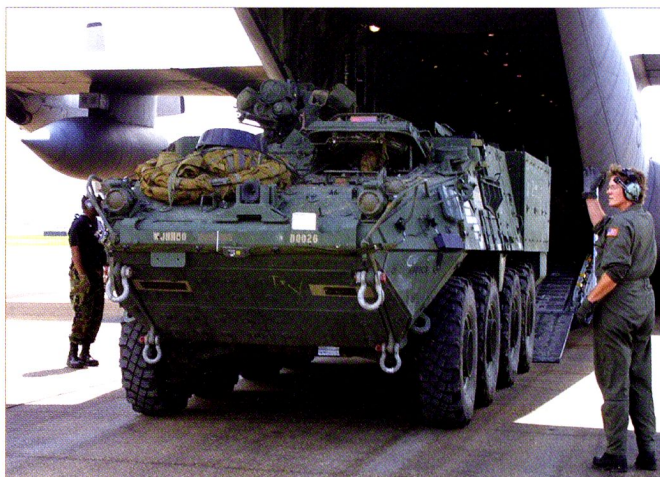
Stryker M1129 déchargé d'un C-130. La place disponible ne permet pas l'emport à la fois du véhicule, du matériel et de la troupe.
