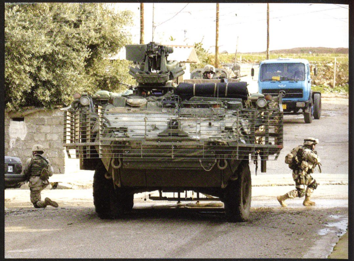
Le problème principal du Stryker en Irak est la largeur de ses blindages additionnels, qui empêchent le croisement dans la plupart des rues.
