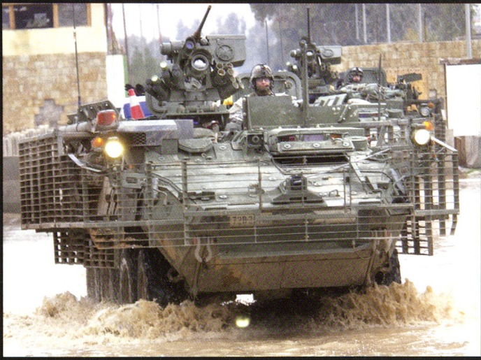
Le Stryker dispose d'une bonne mobilité sur sol dur, mais est vite limité en cas d'obstacle ou de surface meuble.
