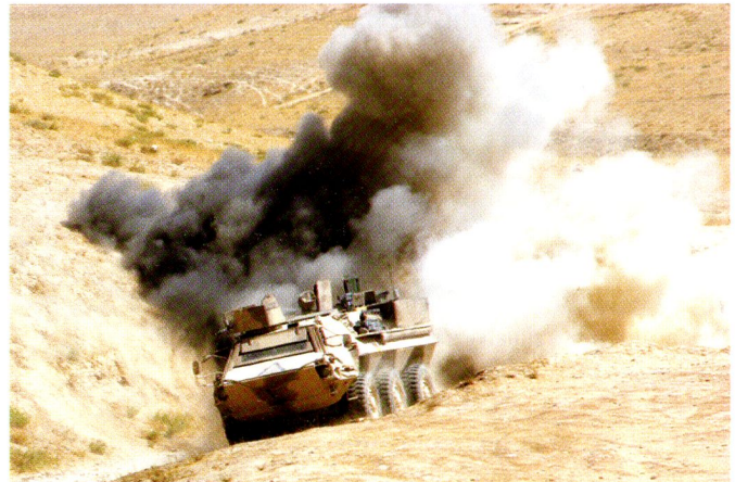
Véhicule de détection NBC Fox (basé sur le véhicule allemand Fuchs) en Afghanistan. Il est utilisé pour la destruction d'explosifs improvisés (IED).
