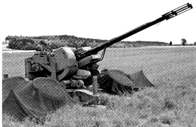
Canon DCA 35mm 63 Oerlikon, le premier canon radarisé du pays, encore en service à l'heure actuelle.
