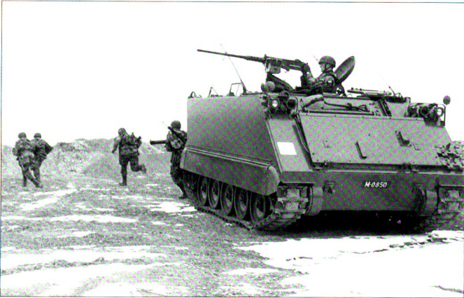
Le M-113 sans tourelleau (char 63) ne dispose que d'une mitrailleuse de 12,7 mm.
