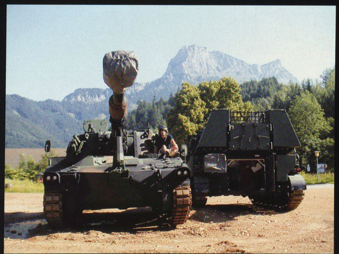
M109A6 Paladin américains. Grande consommatrice de munitions, l'artillerie américaine dispose de véhicules blindés de transport sur châssis M109.
