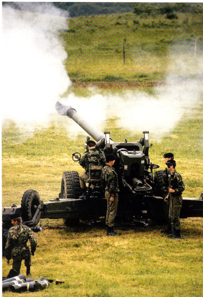
Des pièces d'artillerie tractées disposant de motorisation internes ont été développées jusque dans les années 1980, à l'instar du FH70 britannique.
