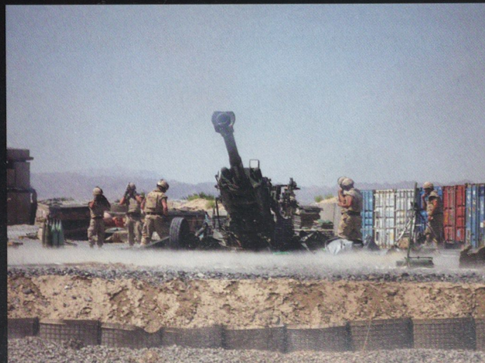
Le M777, également de 155 mm, utilise des matériaux composites pour alléger sa masse et faciliter sa mise en batterie.
