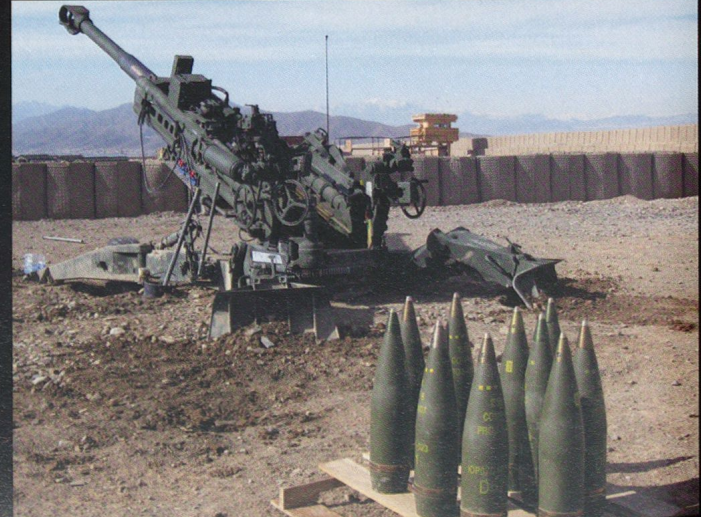
Le M777, également de 155 mm, utilise des matériaux composites pour alléger sa masse et faciliter sa mise en batterie.
