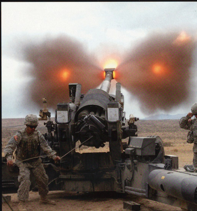
Le M198 est une pièce de 155 mm tractée, en service dans l'US Marine Corps.
