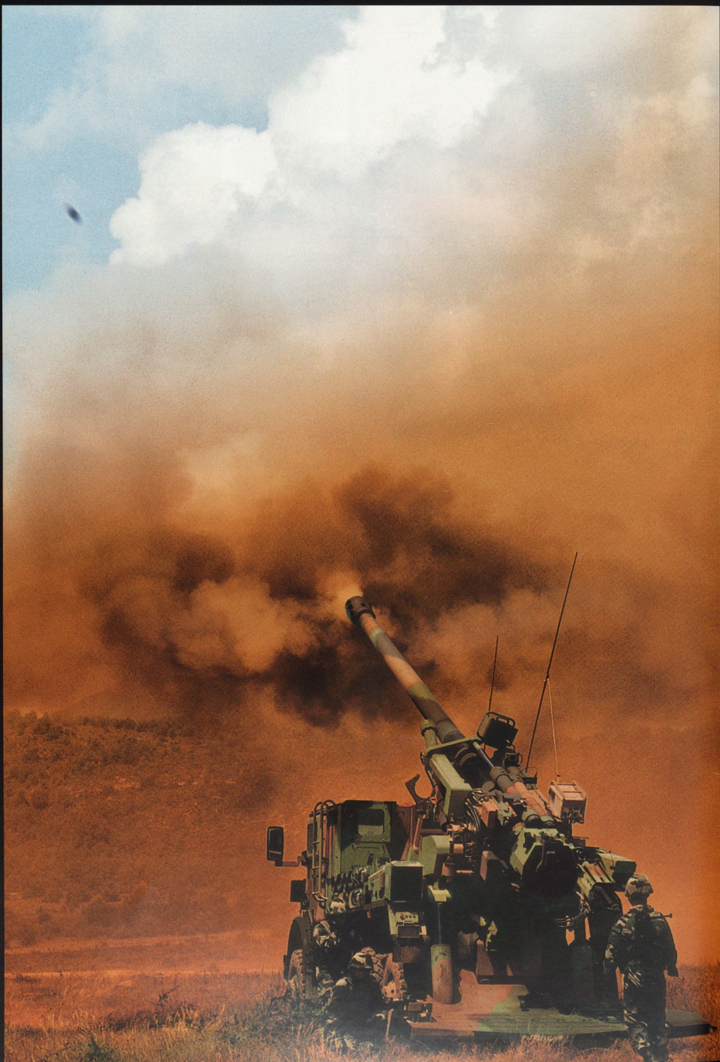
Le César (Nexter) porte, sur un châssis Unimog, une pièce de 155 et de 52 calibres.
