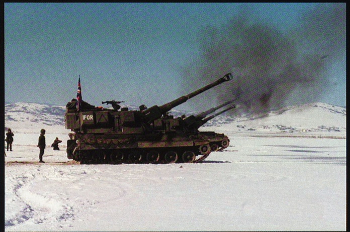
L'AS90 britannique était à l'origine un projet germano-britannique, ayant pour but d'utiliser l'obusier FH70 de 39 calibres. Aujourd'hui, seule la Grande Bretagne utilise ce système.
