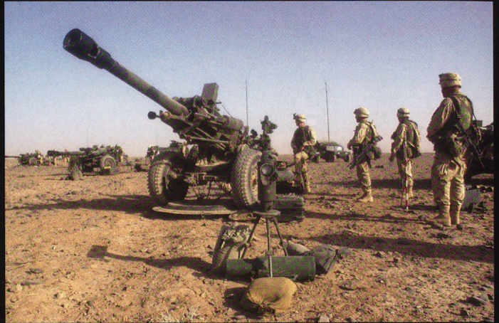
Pièce d'artillerie légère d'origine britannique de 10,5 cm, le M119 est facilement aérotransportable, ou remorquée par un simple Hummer .
