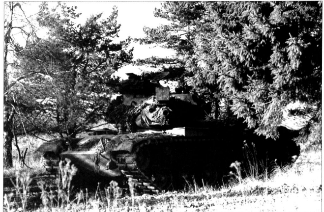
Ils se déplacent à une vitesse maximale de 48 km/h, grâce à un moteur V12 de 750 PS. Les 1'457 litres de carburant interne leur permettent de parcourir 500 km.
