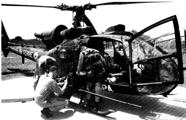
Hélicoptère Gazelle équipée d'un canon de 20 mm en sabord, ainsi que de missiles Mistral . Devant l'absence d'armes guidées pour le Tigre européen, plusieurs Gazelle opèrent au-dessus de la Lybie...
