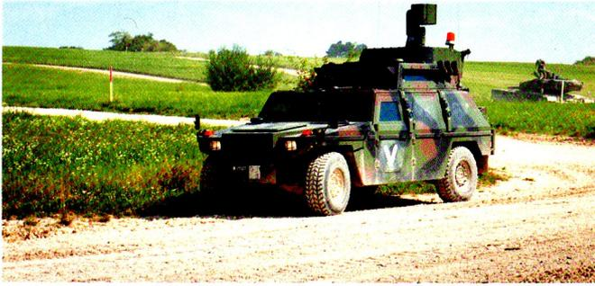
Le véhicule commandant de tir permet de se déplacer sous couvert d'un blindage léger. Ici avec la 17/2.
