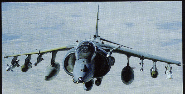
Un GR.9 au-dessus de l'Afghanistan. A noter les nacelles de reconnaissance et de ciblage sous le fuselage.
