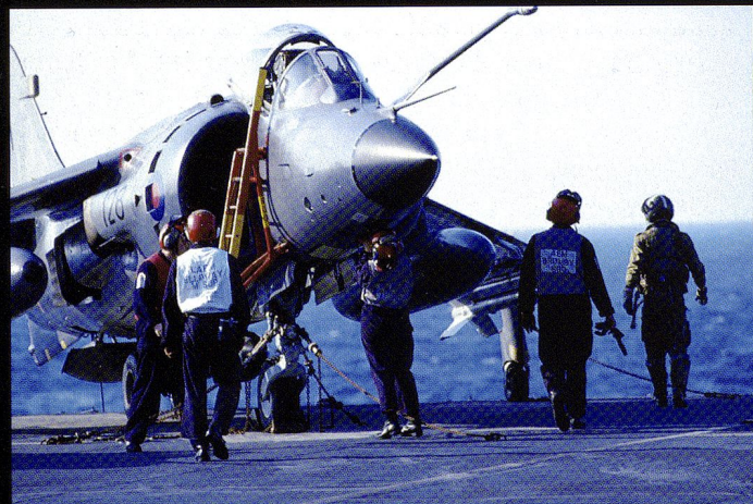
Les Harrier de première génération peut recevoir une perche de ravitaillement fixe ; celle-ci est escamotable sur les appareils de seconde génération.
