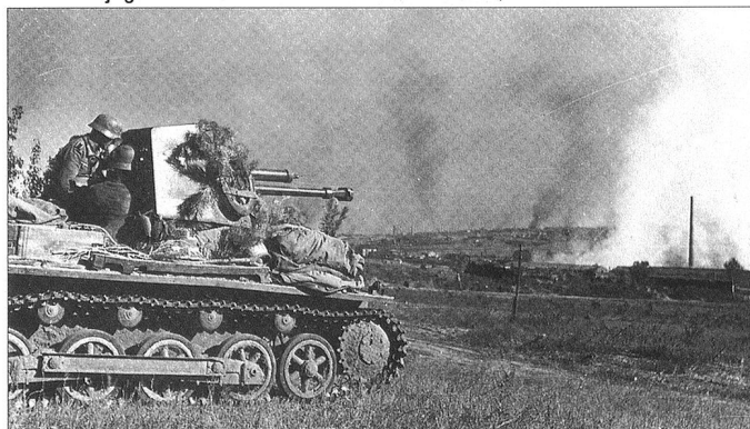
Le Panzerjäger I est armé d'un canon Skoda de 4,7 cm.
