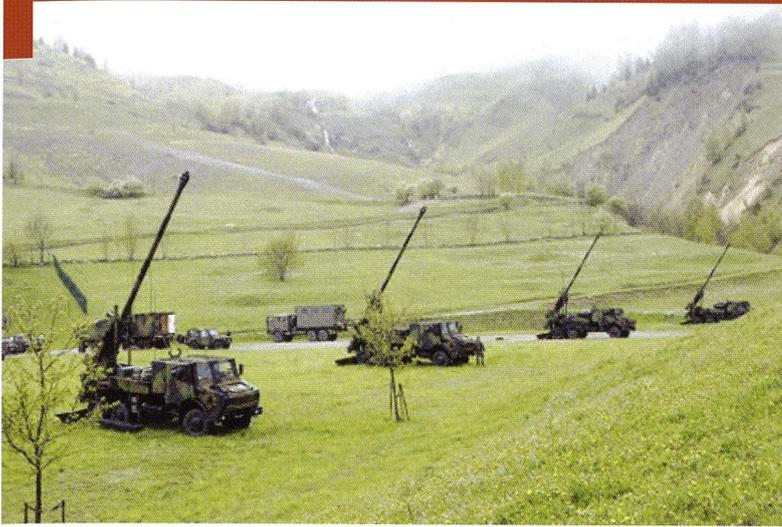
Le système d'obusier autopropulsé *César* français, conçu par l'entreprise GIAT/Nexter a connu son baptême du feu dans les montagnes afghanes. Il monte un tube de 155 mm de 52 calibres sur un châssis Unimog. Sa portée dépasse les 30 km. Un second véhicule est nécessaire pour transporter l'équipe de pièce ainsi que la munition.
