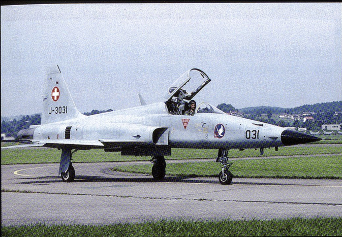
La première série de F-5E, toujours avec son nez d'origine mais déjà équipée de contre-mesures.
