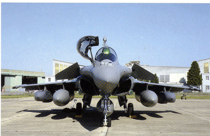
Le Rafale prêt pour une mission d'attaque, chargé de trois bidons de 2'000 litres, quatre Mica et deux missiles de croisière Scalp .
