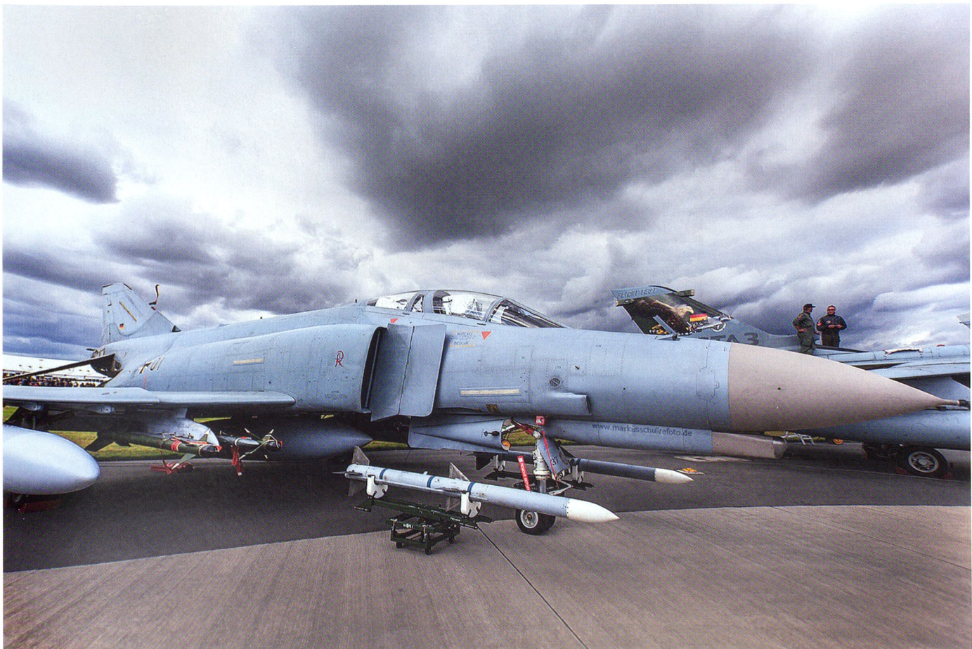
Présentation au sol du F-4F ICE. Celui-ci est armé d'un canon de 20 mm M-61 sous le nez et peut emporter jusqu'à 4 AIM-9 Sidewinder et 4 AIM-120 AMRAAM.
