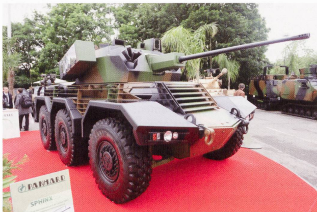
Ci-dessus : Le Sphynx et le Crabe de Panhard sont censés remplacer l'ERC 90 Sagaie et peut-être l'AMX-10RC. Ci-dessous : L'AMX-10RC avec son kit surblindé passe de 17 à 21 tonnes.
