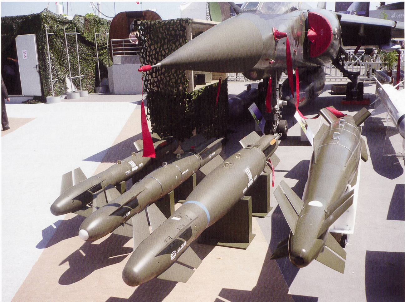
Différentes bombes guidées équipées du kit Armement Air-Sd Modulaire (AASM) de Sagem.
