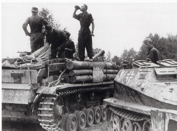
Le half-track Sd.Kfz. 252 de ravitaillement de munition permet de maintenir les canons d'assaut au front.
