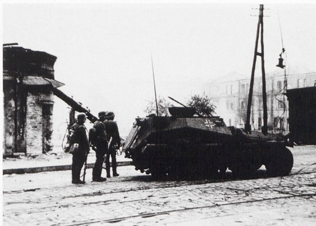
Dans l'organisation de l'artillerie, les commandants de section et de batteries se déplacent dans des véhicules d'observation blindés – à l'instar du Sd.Kfz. 253. Ceux-ci sont progressivement abandonnés, au profit de la pratique des Troupes blindées de conduire depuis les engins de combat.
