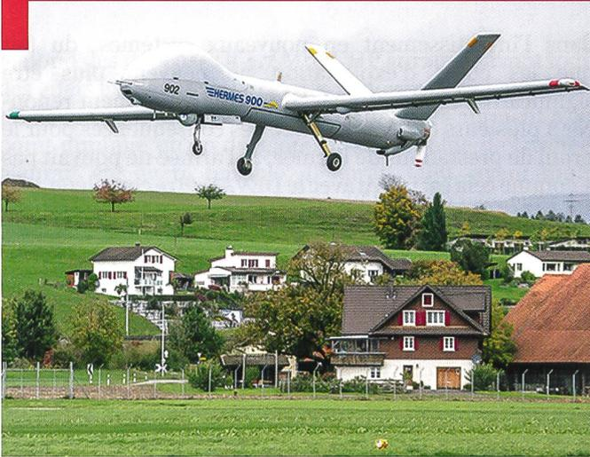
L'*Hermes* 900 a volé pour la première fois le 9 décembre 2009. Il a été introduit en Israël en 2012. Il pèse 1'100 kg et emporte une charge utile de 350 kg. Il vole à 220 km/h au maximum et a une autonomie de 36 heures.
