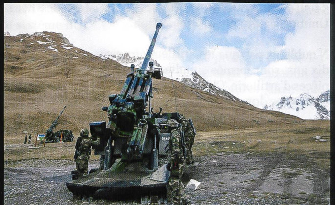
Plus de 77 Césars sont en service au sein de l'armée française. Le système pèse 19 tonnes et est monté sur un châssis Unimog qui confère un certain degré de protection à l'équipe durant les déplacements.
