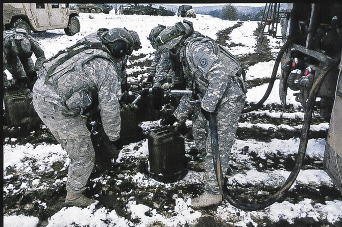
Ravitaillement de Stryker par le biais de bidons, remplis depuis la citerne montée sur un camion tout terrain.
