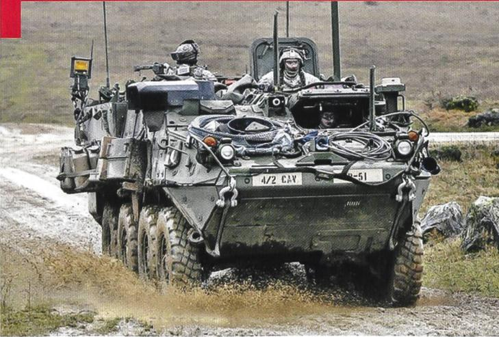
Plus de 4'466 *Stryker* de différents types sont en service dans l'US Army, depuis 2002. Ils pèsent entre 18 et 21 tonnes selon les versions et résistent à des balles de 14,5 mm.
