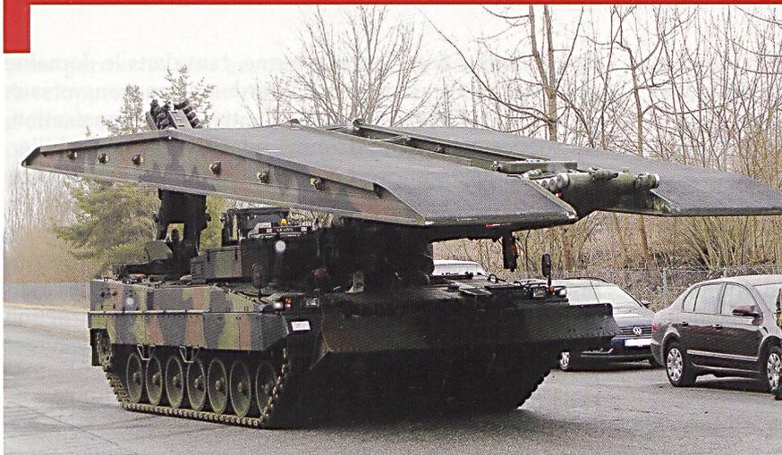
12 nouveaux chars poseur de ponts ont été acquis afin de remplacer le char poseur de ponts 68. Le système permet de poser 1 ou 2 ponts de 14 mètres. Celui-ci est monté sur de nombreux véhicules - en Suisse sur les chassis de chars 87 *Léopard*.
