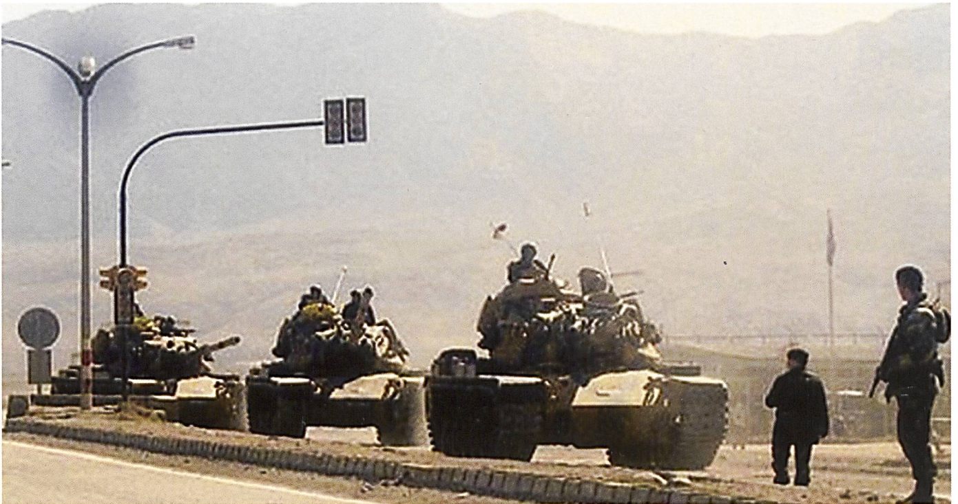
Une section de M60 turque franchissant la frontière avec la Syrie. Conçu à la fin des années 1950, cet engin de 54 tonnes existe en diverses étapes d'améliorations. La plupart disposent désormais de blindages réactifs pour se protéger des armes antichars à courte ou à moyenne portée.
