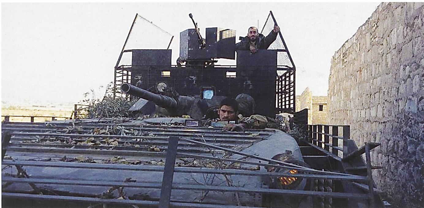
Le BMP1 est un véhicule de combat d'infanterie de 12 tonnes, armé d'un canon à basse pression de 73 mm. Celui-ci tire le même projectile que le lance-roquette RPG7. Sur les engins exportés par l'URSS, le chargeur automatique a le plus souvent été supprimé et le rechargement s'effectue manuellement. La portée et la précision sont faibles. Le débarquement ou l'évacuation des grenadiers par l'arrière est malaisé. Ainsi la troupe prend fréquemment place sur la superstructure du véhicule.
