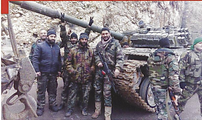
Un T72 de l'armée syrienne équipé de blindages réactifs mais sans armement secondaire ni nébulogènes. L'engin est probablement en panne ou sur le point d'être remorqué. Le maintien en état de matériels sophistiqués est un défi constant.
