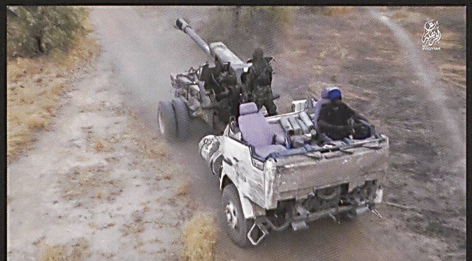
Ci-dessus : Un canon de 122 mm D-30 monté sur le châssis d'un camion léger. Il ne semble pas qu'il soit opérationnel ou alors de façon réduite (pas de mobilité axiale).
