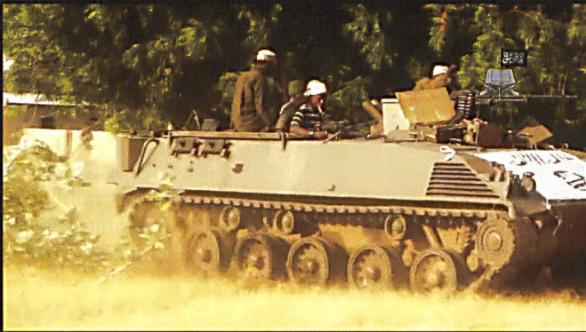
Ci-dessus : Un blindé nigérian (Saurer 4K 4FA) capturé par BH progresse lentement. Il est armé d'une mitrailleuse 12.7 mm NSV.
