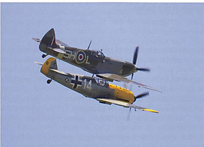
négatifs, le moteur cale. Il est alors nécessaire d'adapter les tactiques et d'apprendre aux pilotes de la RAF d'effectuer un demi-tonneau avant de plonger.
