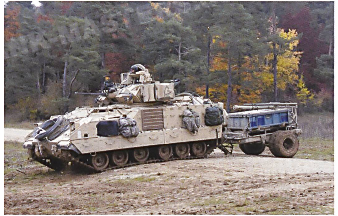
Un M2 emporte une charge de déminage MICLIC. Toutes les photos de cette page concernent les exercices de la 3 rd I.D. en 2016 en Allemagne.
