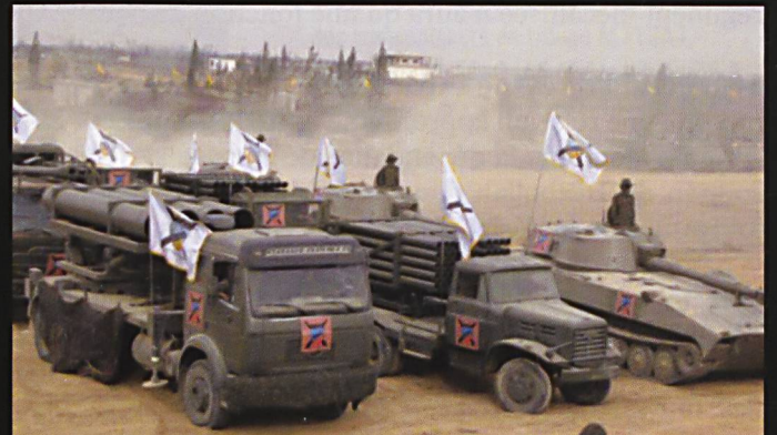
Quatre tubes de 302 mm sur châssis de camion, 2 copies de BM-21 à 50 tubes, deux 2S1 Gvozdika .
