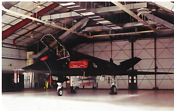
Ci-dessus : Dans son hangar climatisé, un appareil attend son envol. On constate deux conteneurs de munitions d'exercice fixés aux « trapèzes » de la soute à bombes interne du F-117.
