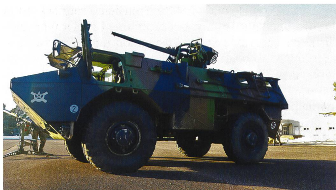
Un véhicule de l'avant blindé (VAB), ici en configuration anti-aérienne, avec un canon de 20mm, et portant l'emblème du 68 e régiment d'artillerie d'Afrique (68 e RAA).
