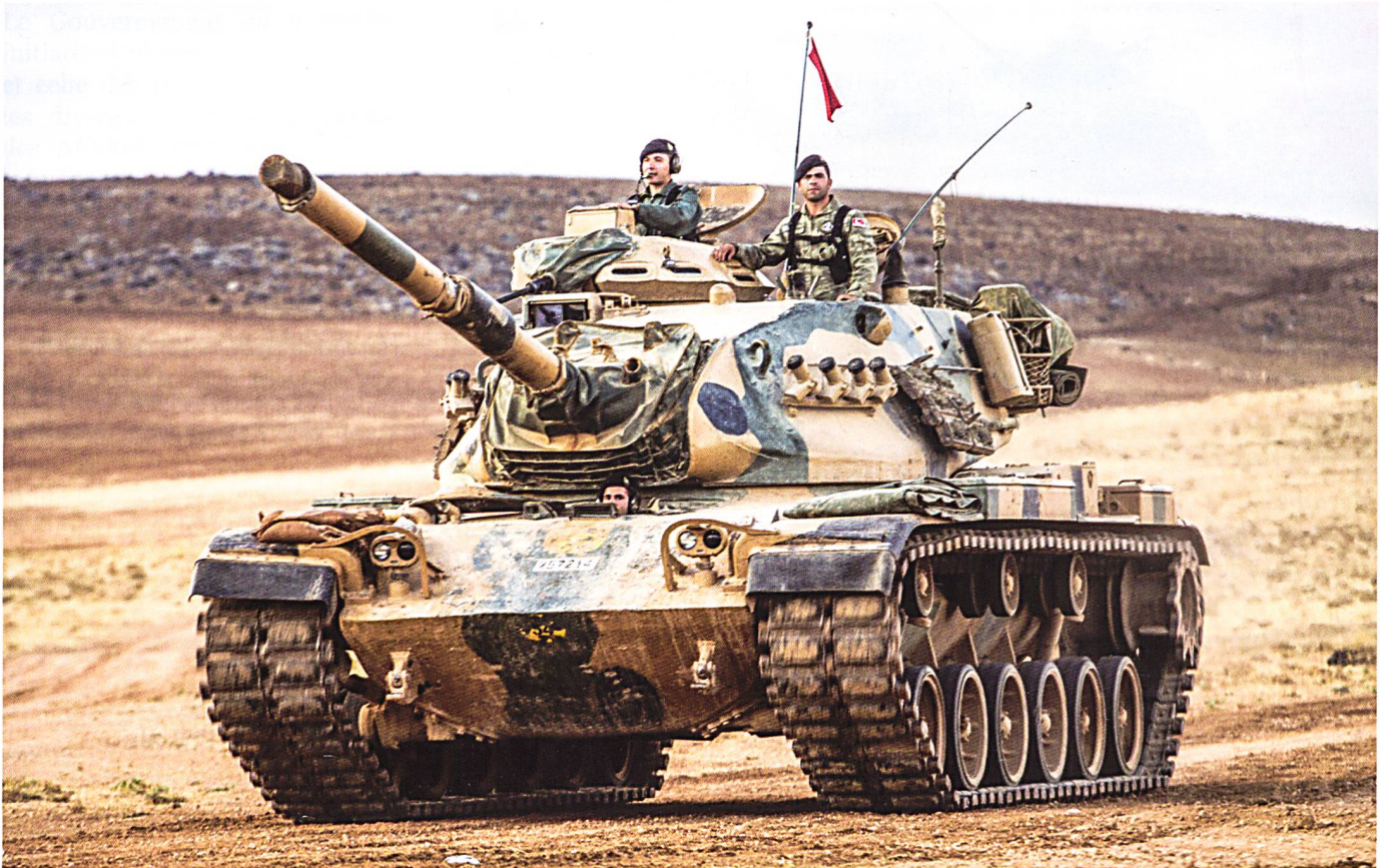
Chars turcs M-60 A3 armés du canon d'origine de 10,5 cm rayé M68. Ces engins sont conformes à la configuration de l'USAREUR des années 1980. Le canon d'origine est le L7 de 10,5 cm L52- une arme développée par les ateliers britanniques de la Royal Ordnance.
