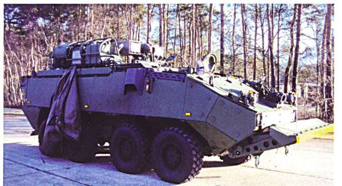
Ci-dessous : La version de dépannage (Recovery) est dotée d'une lame ainsi que d'un atelier diagnostique et réparation mobile.
