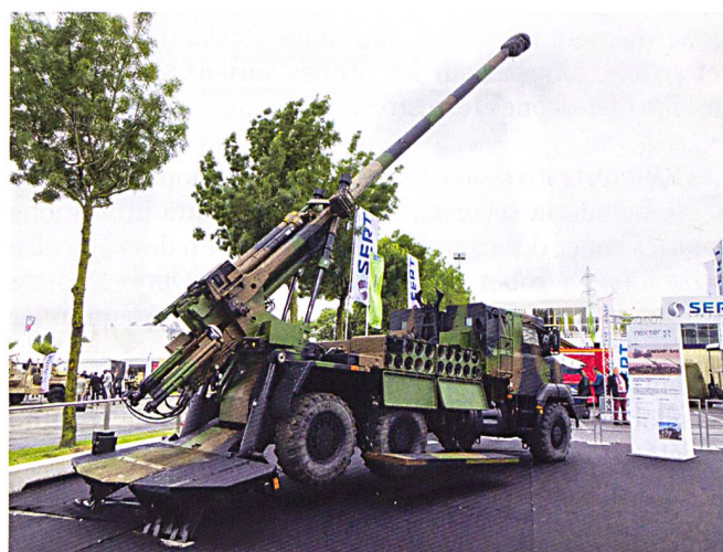
Ces deux illustrations présentent l'évolution du système, à partir d'un châssis 6x6 léger et aérotransportable, vers un châssis 8x8 plus résilient et plus autonome. Photos © A+V.
