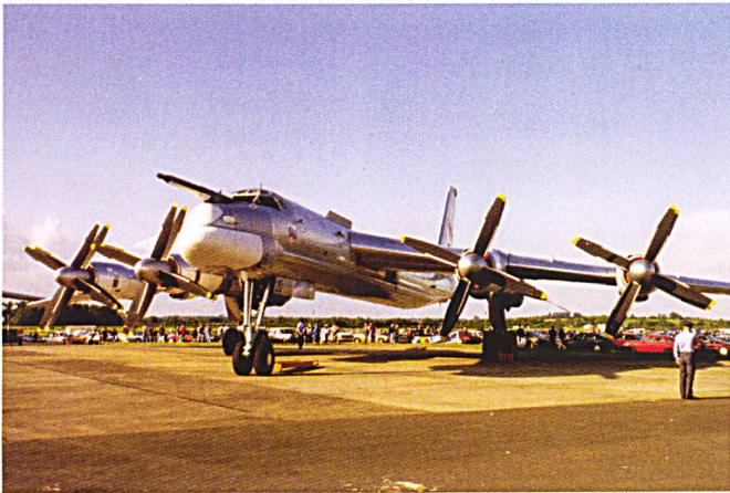
Le Tu-95 Bear F avec ses quatre moteurs et ses doubles hélices contrarotatives.
