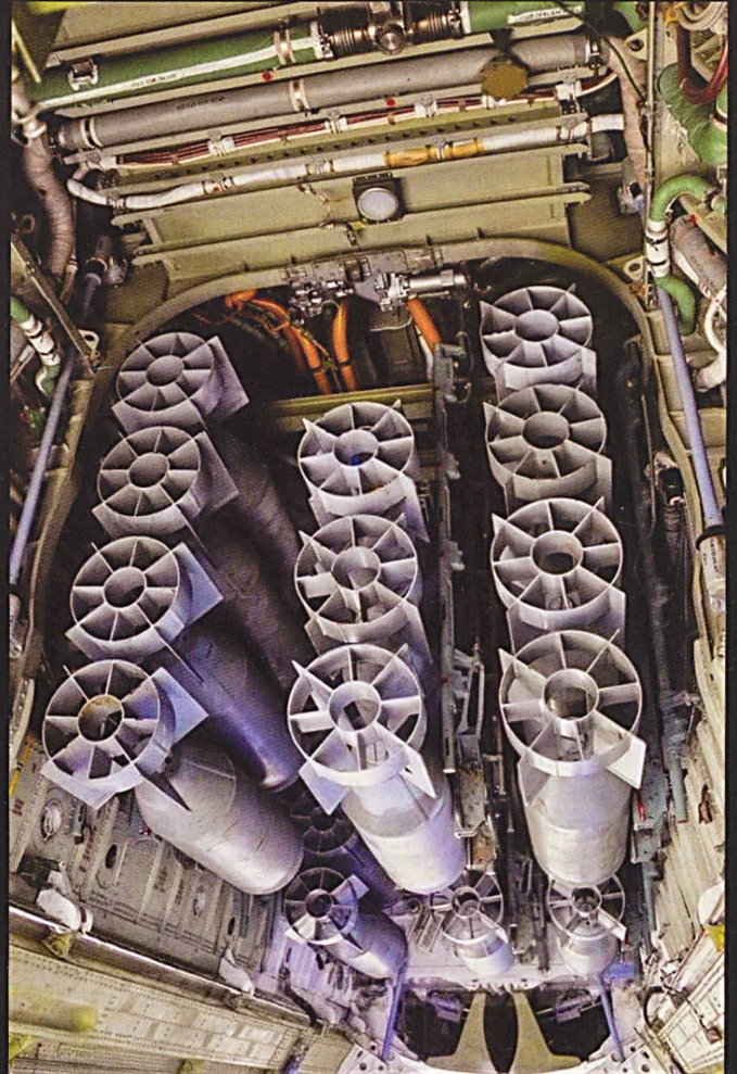
Ci-dessus : Deux vues montrant l'engagement des Tu-22M russes au-dessus de la Syrie. Cet appareil est plus polyvalent que les autres types. Il peut emporter jusqu'à 69 bombes FAB-250 ou 8 bombes FAB-1500. Le dernier chiffre indique le poids de la munition.
