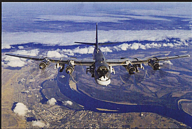
Ci-dessus, à gauche : Deux vues de Tu-95 dotés de pylones pour l'export de missiles de croisière. Sur la photo du haut, les armes sont chargées.
