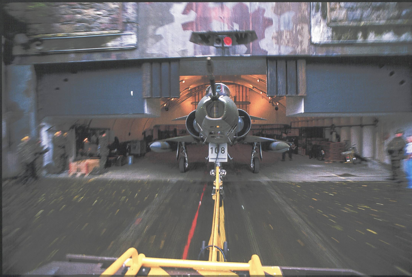
Les étapes des préparatifs au vol d'un AMIR. L'appareil peut démarrer son moteur à l'intérieur de la caverne et le remorqueur peut le libérer en roulant - afin de minimiser le temps de décollage.
