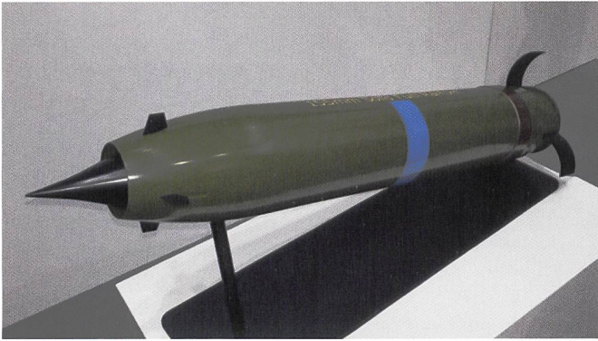
Obus de 15.5-cm avec statoréacteur de Nammo pour une portée jusqu'à 100 km. Photo © Nammo AS.
