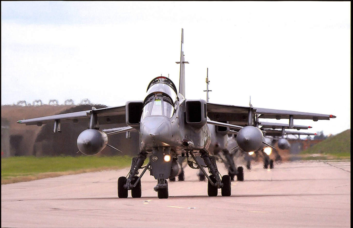
Le Jaguar B français et T2 britannique, conçus pour l'entraînement, se ressemblent davantage que leurs homologues monoplaces. On reconnaît cependant les appareils britanniques à la nacelle de l'avertisseur radar (RWR) installé sur la dérive. Toutes les photos © RAF.
