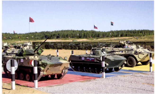
Le véhicule de combat d'infanterie ZBD-03 (à gauche) est comparativement plus grand mais également plus léger que son homologue russe le BMD.
