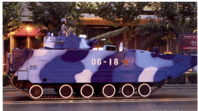
Le ZBD-05 amphibie est employé par des unités de l'armée de Terre comme de la Marine. Il est équipé d'une tourelle de 105 mm et peut également engager des missiles antichars. L'engin du haut est vu dans la livrée portée par les unités de Marine.
