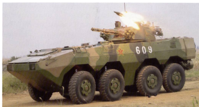
Le ZBL-09 dispose d'une tourelle de 30 mm mais est également capable d'engager des engins guidés antichars.
