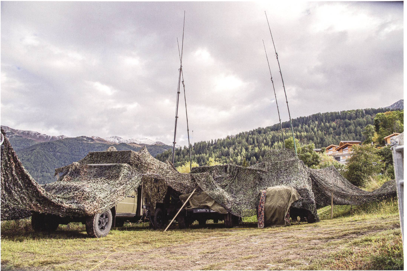
Ci-dessus : Une « ferme d'antennes » permet aux emplacements réels des échelons et postes de commandement d'échapper à l'exploration électronique. Ci-dessous : La compagnie de sûreté a pour mission de protéger les infrastructures de conduite mobiles et fixes de la brigade. Photos © Br mec 1
